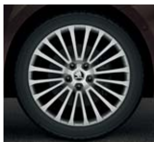
Disky z ľahkých zliatin* 7.5J × 18" SIRIUS pre pneumatiky 225/40 R18 v striebornom vyhotovení.
