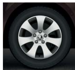
Disky z ľahkých zliatin 7.0J × 16" SPECTRUM pre pneumatiky 205/55 R16.
