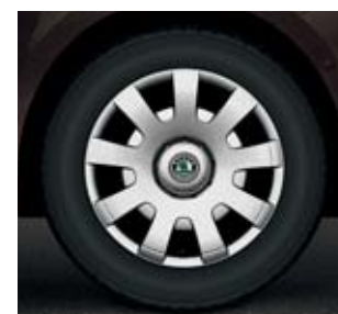
Oceľové disky 7.0J × 16" pre pneumatiky 205/55 R16 s krytmi diskov TEMPEL .
